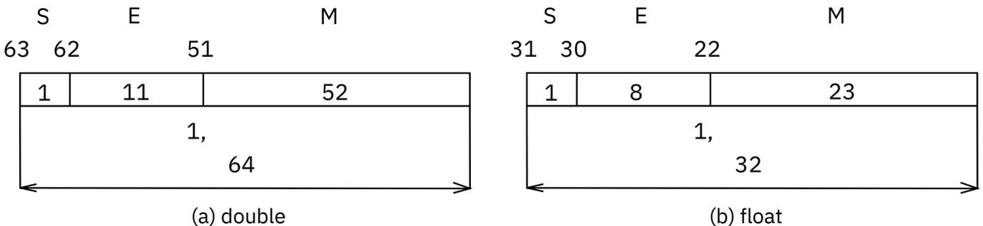
Рис. 4: Типы с плавающей запятой
