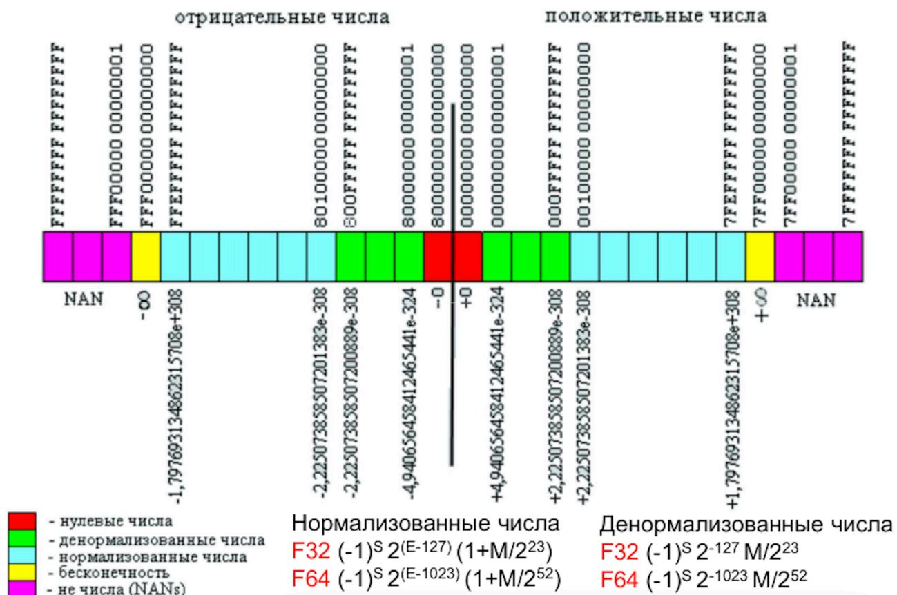
Рис. 10: Особенности работы с числами с плавающей запятой
