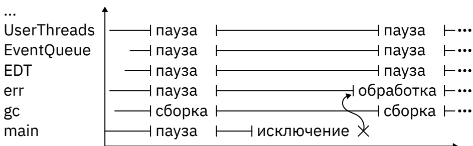
Рис. 26: Принципиальная схема работы приложения
